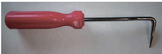
Рисунок 18. Пробник для проверки качества шва
